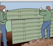
Die Enden der Motivplatten müssen zur Lastverteilung auf dem Fundament aufliegen.
