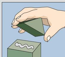
Zubehörteile (Pfostenkappen und Oberlatten) mit Flexkleber montieren. Bei Montage der Rechteckoberlatte stehen die Motivplatten ca. 4 cm tiefer als die Pfostenoberkante. Dazu schneidet man die unterste Motivplatte im Element entsprechend der Dicke der Oberlatte ein. Zum Abschluss des Rohbaus Zaunelemente reinigen.
