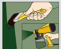
Zum dauerhaften Betonschutz: Zaun mit Beckers Betonzaunfarbe behandeln. Farbe gut aufrühren und mit max. 10% Wasser verdünnen. Ergiebigkeit beträgt je nach Oberfläche und Struktur ca. 0,4 Liter/m<sup>2</sup>.
