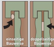
Motivseite an Pfosten drücken und mit einem passenden Stein in der Nut verkeilen. Bei doppelseitiger Bauweise: Motivseiten an Pfosten drücken und mit einem passenden Keil nach außen verkeilen.
