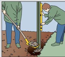
Ersten Pfosten einbetonieren (Kies-Sand-Zement-Gemisch; Betongüte C16/20 erdfeucht). Auf lotgenaues Ausrichten achten. Die Zaunelemente werden immer waagrecht verbaut.
