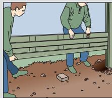
Erste Motivplatte nach gewünschter Flucht in die Nut setzen. Ende der Platte mit einem Pflasterstein als stabile Auflage unterlegen und in Waage setzen.
