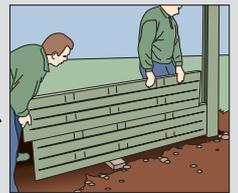
Motivplatten bis zur Oberkante der Pfosten einsetzen und weiter verkeilen. Achtung, einige Motivplatten werden im Wechsel verbaut (siehe Lieferschein).
